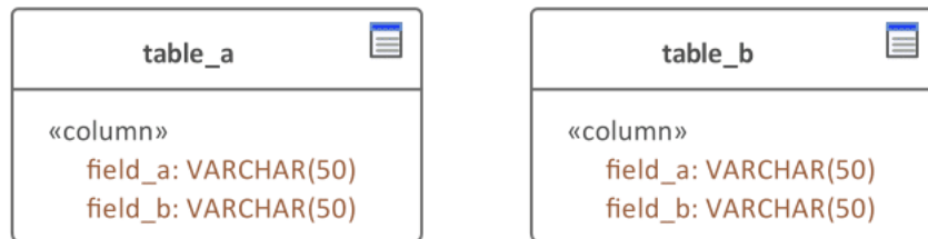
Рисунок 2.1.f — Схемы отношений для демонстрации эффекта дублирования имён атрибутов при выполнении SQL-запроса с JOIN
