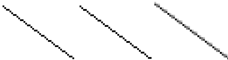
Рис. 2.18. Отрезки, построенные по алгоритмам DDA, Брезенхема и Ву
